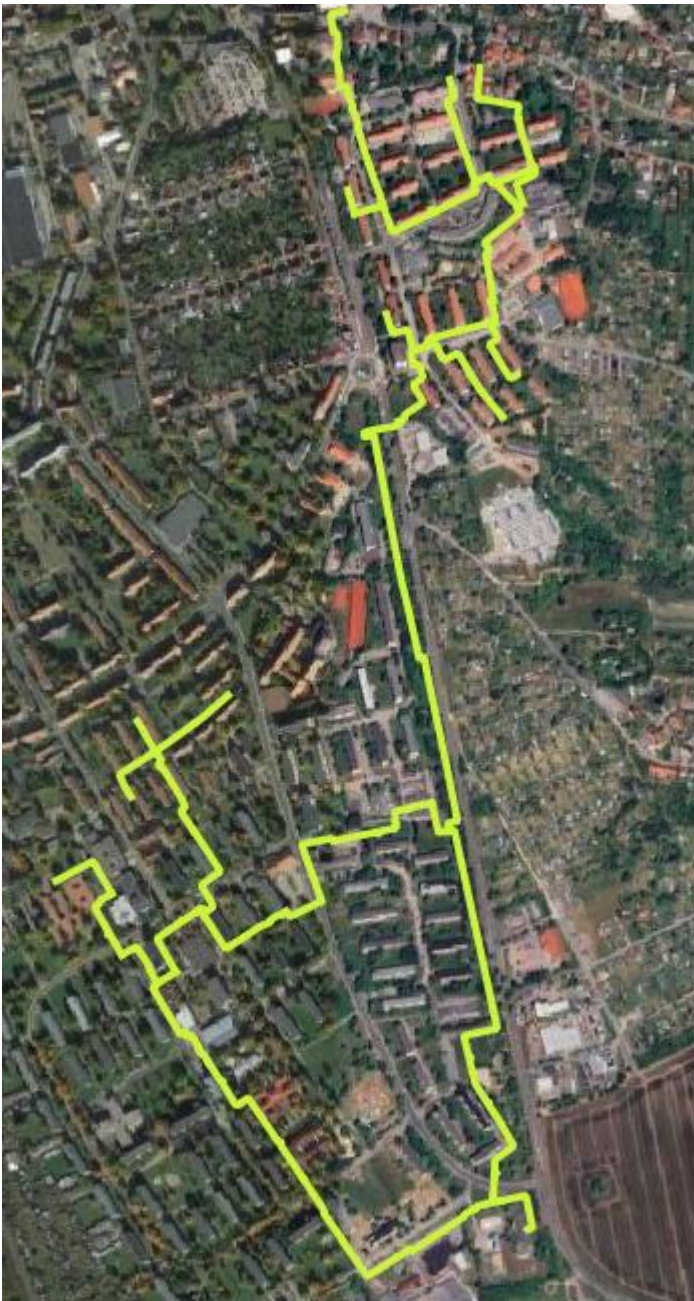
Abbildung 21: Wärmenetz I der Stadtwerke Sangerhausen GmbH
