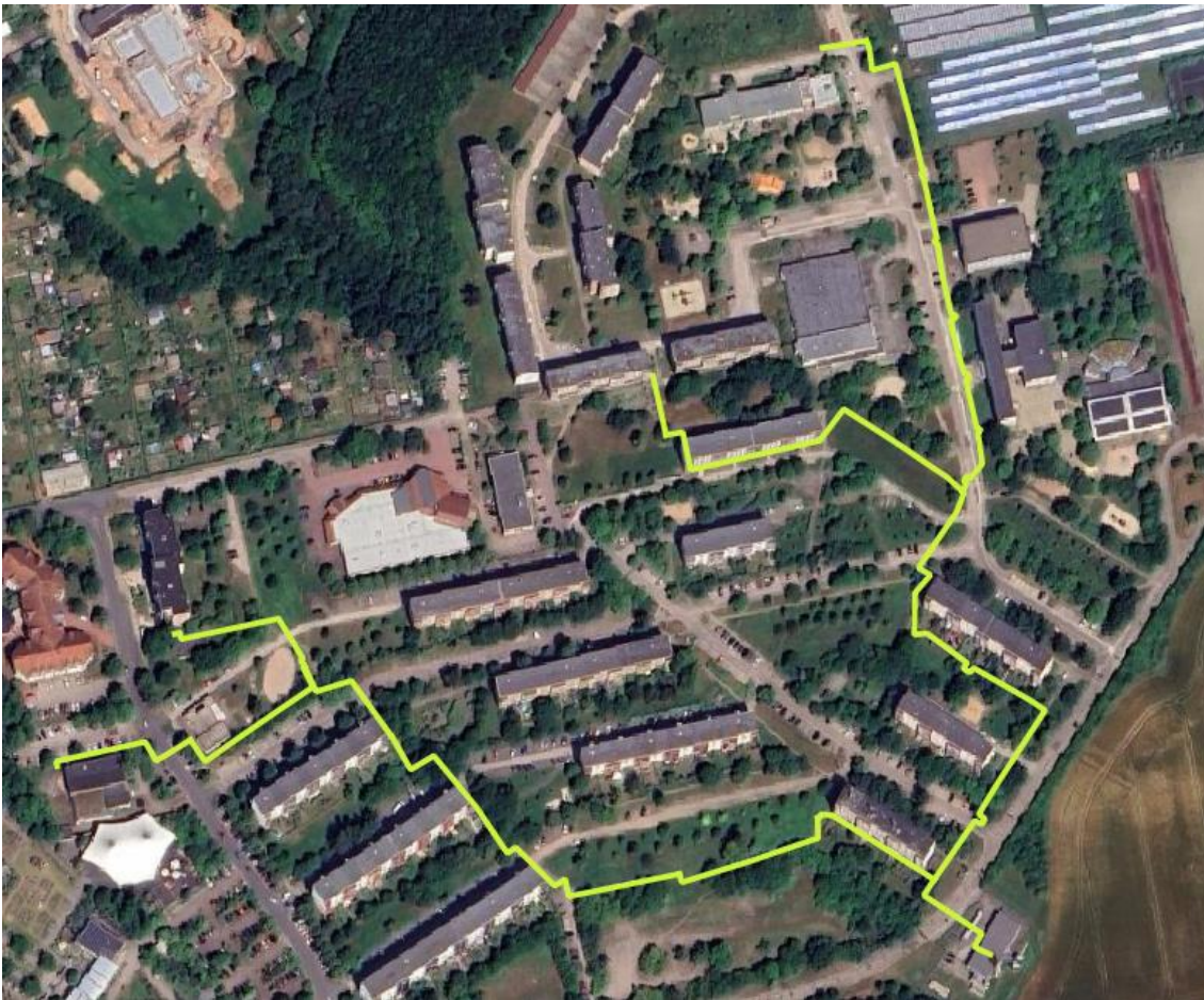
Abbildung 22: Wärmenetz II der Stadtwerke Sangerhausen GmbH
